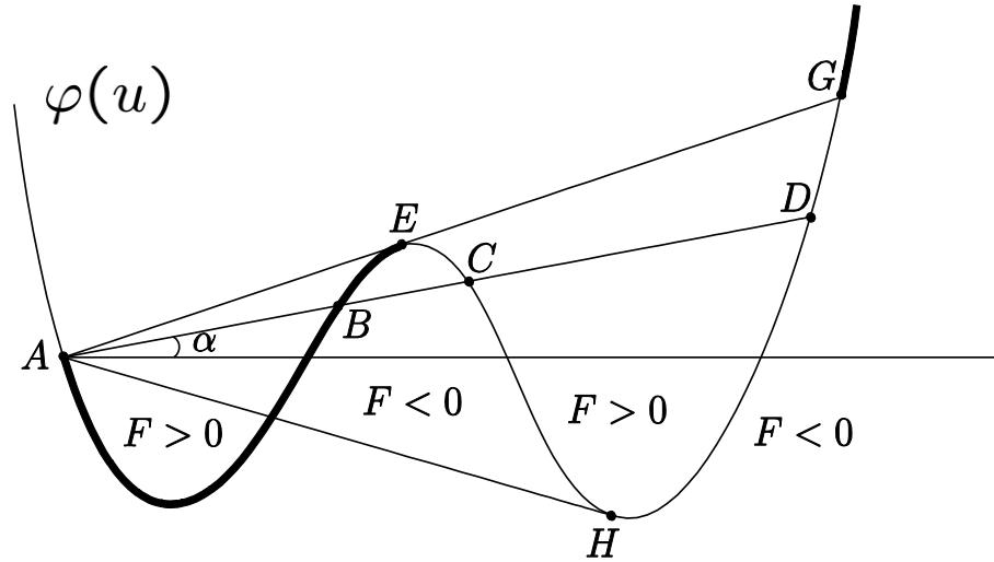
$F(u)$  - при фикс.  $u$  разность ординат секущей и кривой  $\varphi(u)$
