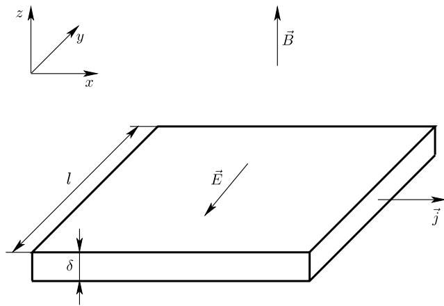
направлении оси  $(x)$  запускался постоянный электрический ток с плотностью  $\vec{j}$ . Свободные электроны под действием силы Лоренца, индуцированной магнитным полем, начинали двигаться вдоль оси  $(y)$ . В результате возникала разность потенциалов в направлении оси  $(y)$  между краями пластины и сопутствующее ей электрическое поле  $\vec{E}$ .
