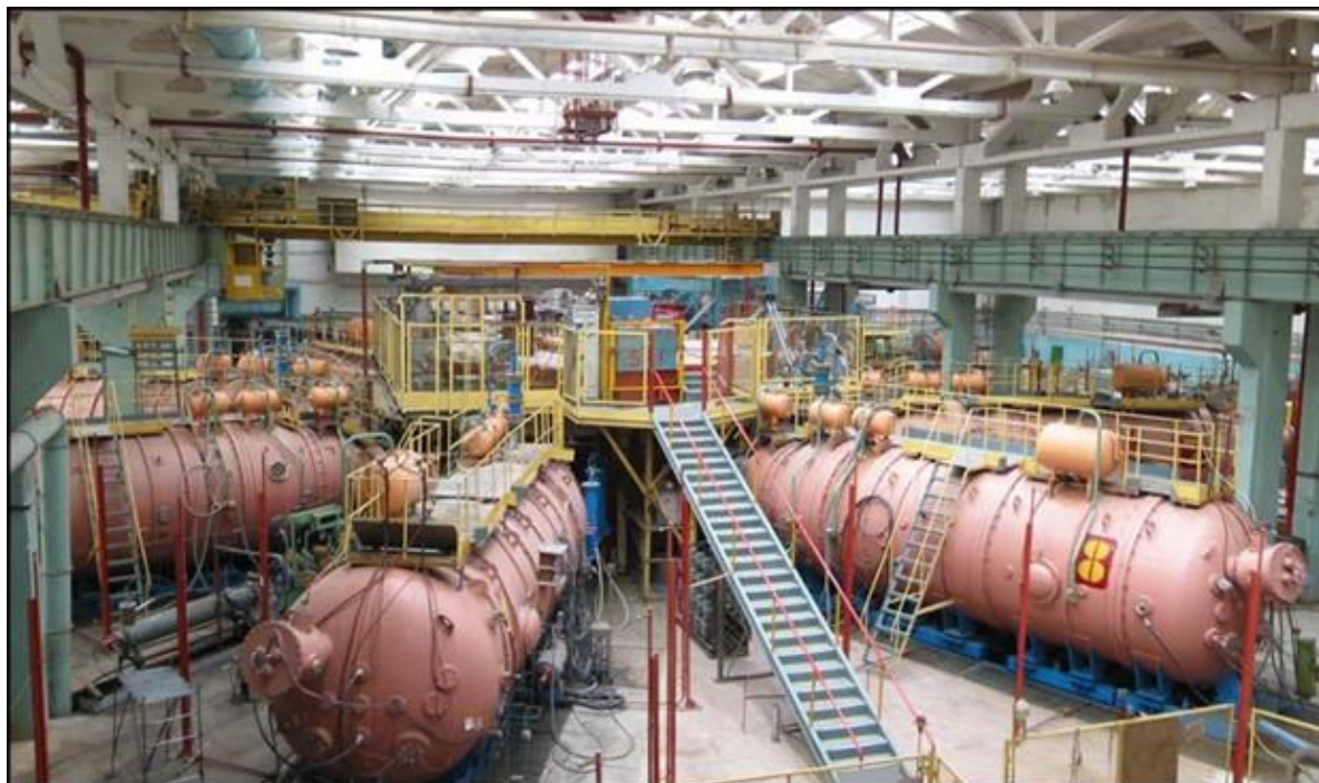
Сильноточный генератор АНГАРА-5-1
