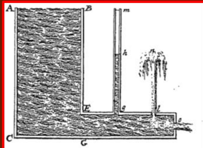
Бернулли показал, что давление, оказываемое движущейся жидкостью на стенки, меньше статического давления, причем разница равна половине квадрата скорости, умноженной на плотность.
