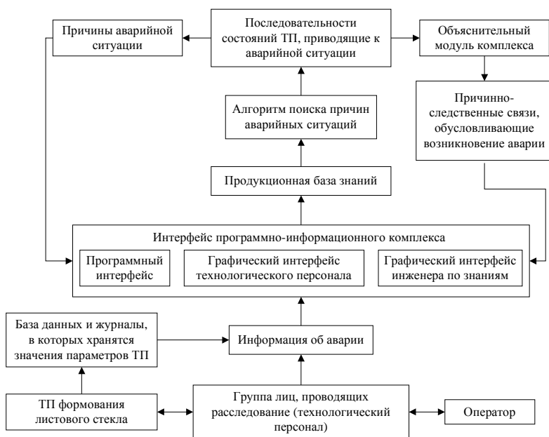
Рис. 1. Структура и состав программно-информационного комплекса
