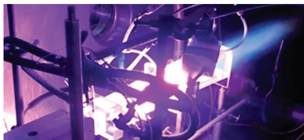
Рис. 1. Фотография плазменно-стимулированного горения пропан-воздушной смеси в расширяющемся аэродинамическом канале длиной 50 см.
