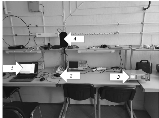
Рис. 1. Экспериментальный стенд для поиска сигналов ВЧО при помощи SDR HackRF One:
