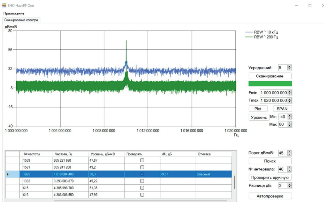
Рис. 3. Вид экрана – результаты обработки и отображения принятого сигнала при помощи разработанного ПО для HackRF One на частоте 1 ГГц
