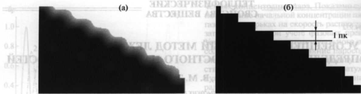
Рис. 2. Фрагмент контура изображения лежащей капли: (а) – до преобразования; (б) – после преобразования.
