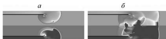
Рис. 5. Две последовательные стадии процесса распространения детонационной волны при импловзивном методе перепуска детонации из щелевого зазора в камеру в случае разбавленной смеси H_2 : O_2 : N_2 = 2 : 1 : 7
