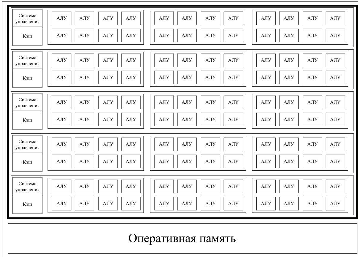
Рис. 2. Схематическое изображение графического адаптера (GPU)
