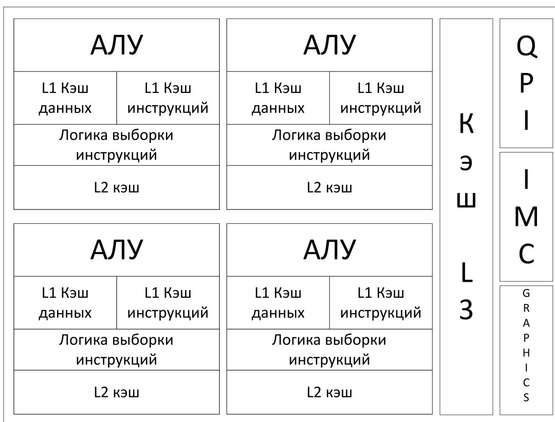
Рис. 1. Схематическое изображение архитектуры центрального процессора Intel Nehalem (CPU). Изображенная площадь устройств пропорциональна их площади на реальном кристалле
