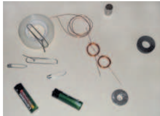
Рис.5. Детали для сборки электромотора
