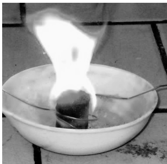
Рис. 4. Горение сухого брикета Fig. 4. Burning of the dry briquette
