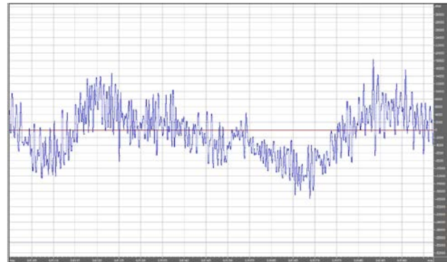
Рис. 2. Акустический спектр сразу после включения. Длительность 0,009 сек.
