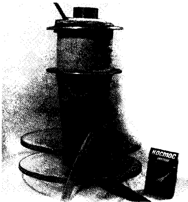
Рис. 4. Общий вид ВМГ с двумя каскадами перед экспериментом.
