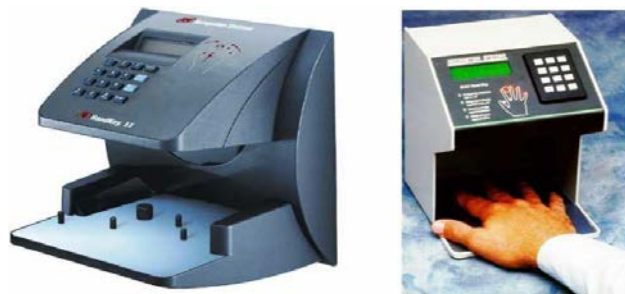
Рис. 9. Устройство идентификация по геометрии кисти руки и способ ее применения.
