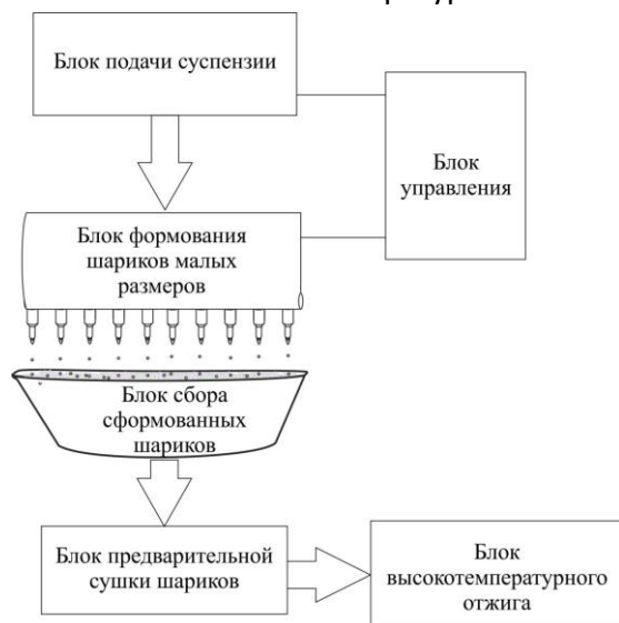
Рис. 2. Блок-схема установки для формирования керамических шариков малых размеров.
