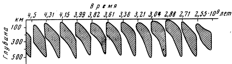
Рис. 3. Форма циклов проплавлений верхней мантии при параметрах модели \lambda = 0,07 \text{ кал/см·сек·град} и \lambda_{эф} = 0,1 \text{ кал/см·сек·град} и уменьшения \epsilon до 10 \text{ см}^{-1} в твердом верхнем слое. Число циклов 13, период их 170 млн. лет
