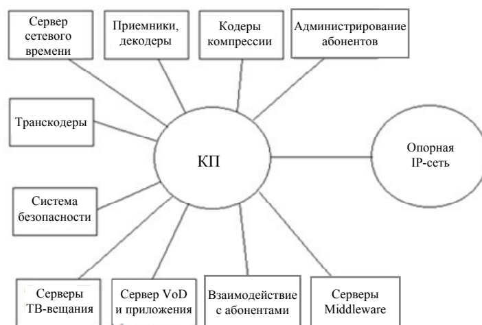
Рис. 1. Функции головного IP-коммутатора: КП – коммутационное поле
